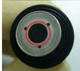
步驟 4：組裝熱氣電磁閥，依反向程序將各元件裝回，再將兩支十字螺絲平均鎖回即可。
